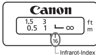
Der Infrarot-Index dient zur Korrektur der Scharfeinstellung beim Fotografieren mit Schwarzweiß-Infrarotfilm. Nach der manuellen Scharfeinstellung stellen Sie die Entfernungsskala, die durch den Entfernungswert angezeigt wird, vor der Aufnahme ein, indem Sie den Scharfstelling weiter auf den Infrarot-Index drehen.
