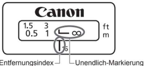
Um das Verschieben des endgültigen Fokuspunkts auszugleichen, das durch Änderungen der Temperatur auftritt, gibt es einen Spielraum an der Unendlich-Position ( $\infty$ ). Bei Normaltemperatur liegt Unendlich-Einstellung vor, wenn der senkrechte Arm der Markierung "L" der Entfernungsskala mit dem Entfernungswert fluchtet.
